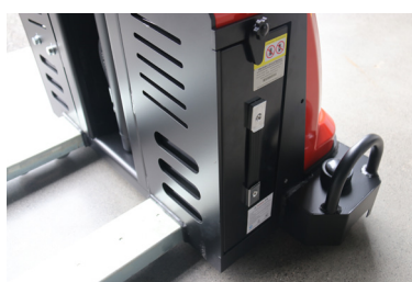
Accès à la batterie via trappe latérale
